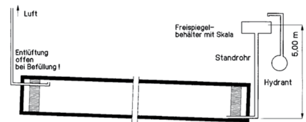
Bild 10 Prüfung auf Wasserdichtheit
